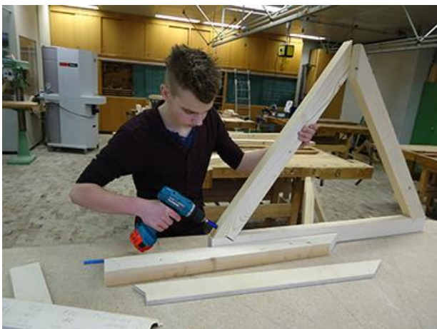
Die Gebinde werden montiert.
