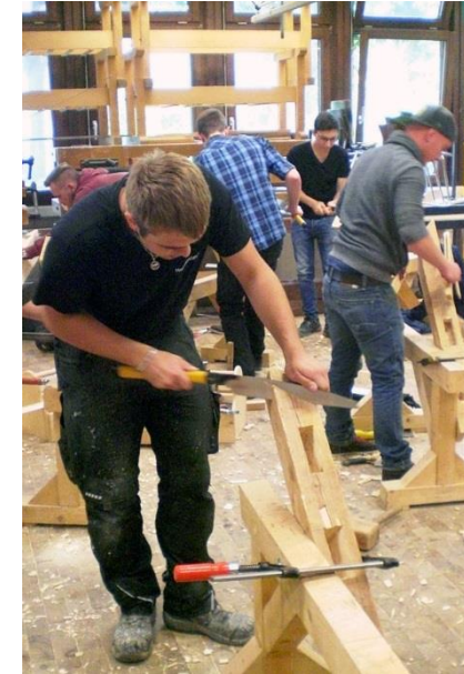
Schifterschnitt mit Japansäge
