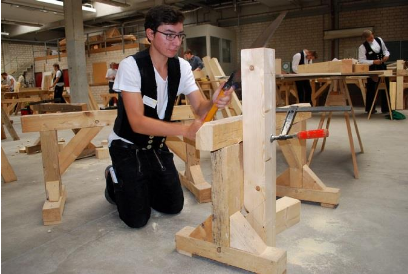
Ausarbeiten einer Verbindung mit der Japansäge
